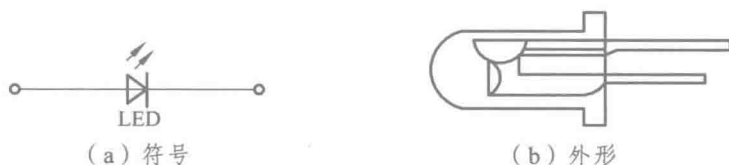
图 1.17 发光二极管的符号和外形
