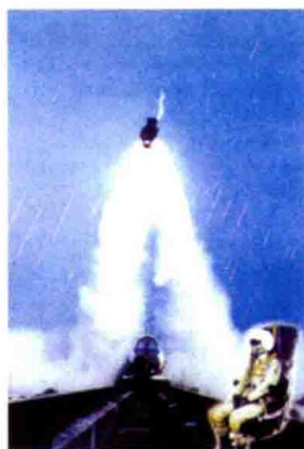
正在进行弹椅实验
