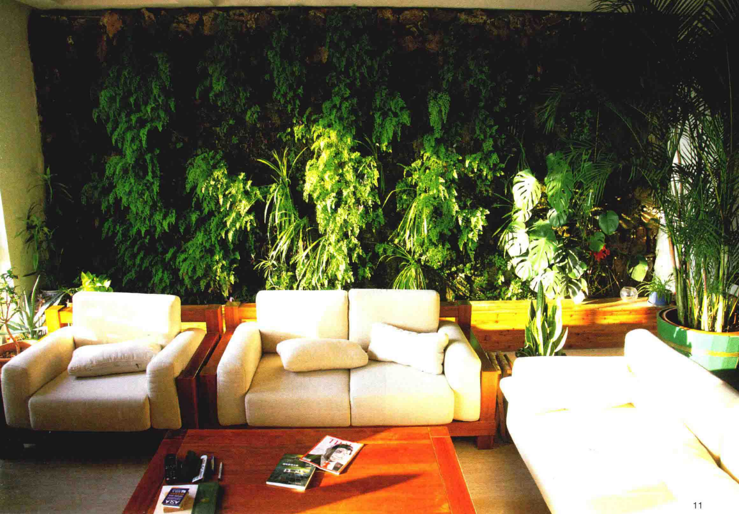
图11 生态墙建成后效果。在炎热的夏季，蕴含水分的墙体带来了阵阵冷空气，替代室内空调的使用；在干燥的冬季，带来充沛的湿气，减少加湿设备的运转
