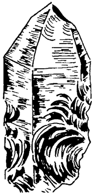
图 1—3 单晶石英的贝壳状断口
