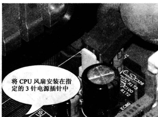
图 1.1.16 将 CPU 风扇安装在制定插针
