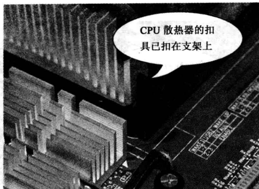
图 1.1.14 散热器扣具扣在支架上
