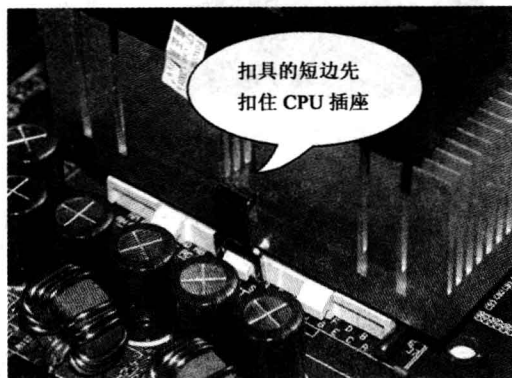
图 1.1.11 把风扇的一个侧面放到 CPU 上
