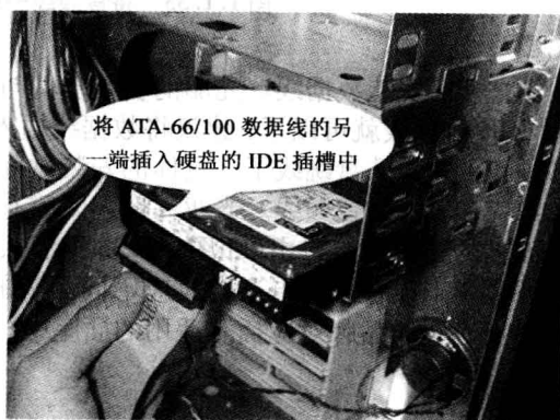
图 1.1.31 将数据线另一端接入硬盘的 IDE 插槽
