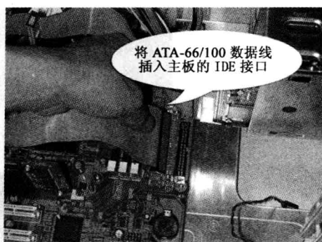
图 1.1.30 将数据线一端插入 IDE 接口
