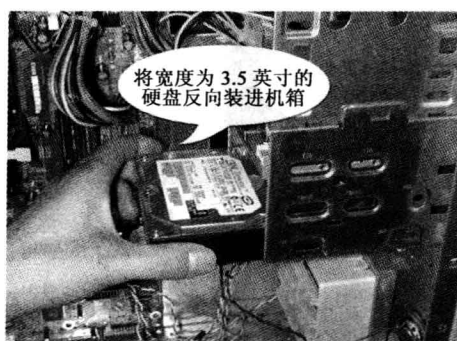
图 1.29 将硬盘反向装进机箱
