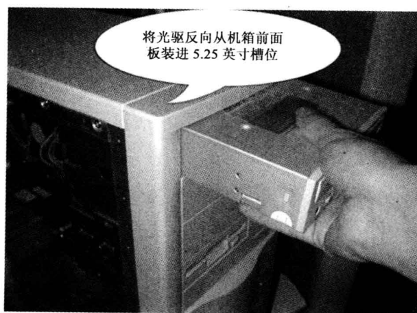
图 1.1.32 将光驱反向插入槽位
