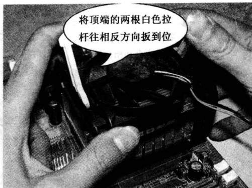
图 1.1.15 将顶端的两根白色拉杆扳动到位
