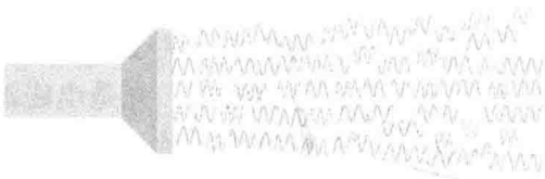
图 1.1 手电筒发出光波波列的示意图
