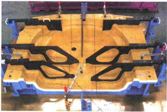
图 1-6 车身冲压件检测夹具
