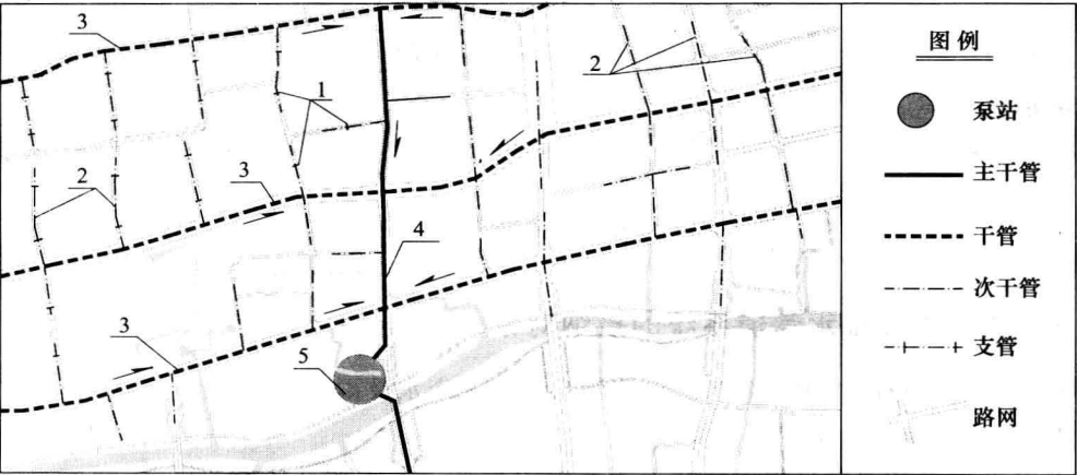
图 1-2 市政污水管道系统平面图
