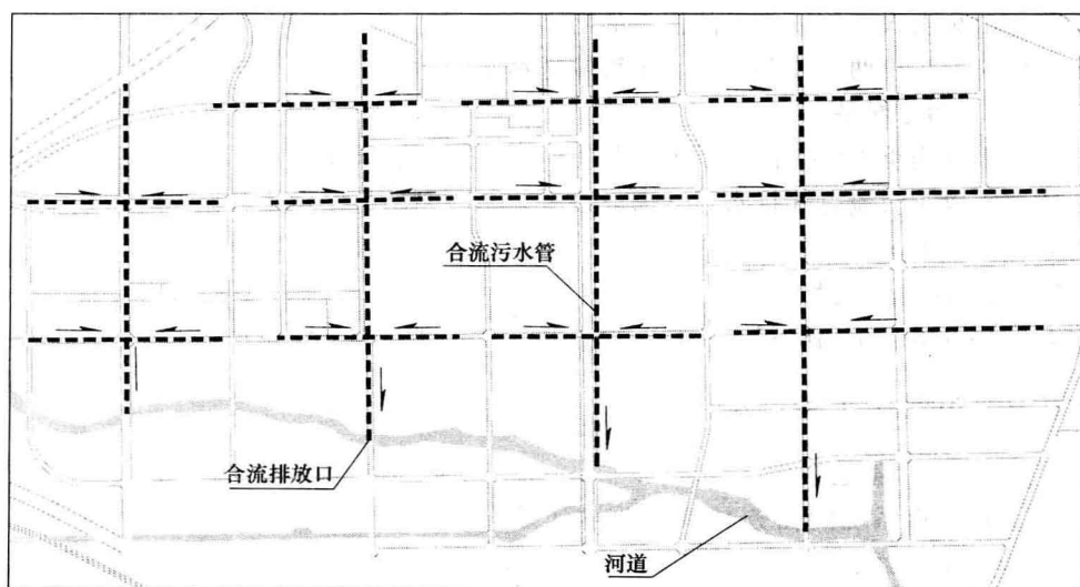
图 1-3 直排式合流制排水系统
