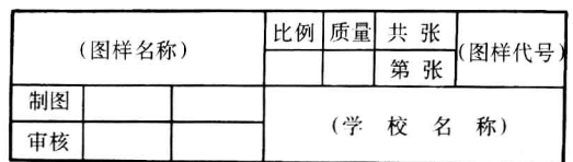
图 1-13 制图作业用简化标题栏 a) 零件图标题栏 b) 装配图标题栏
