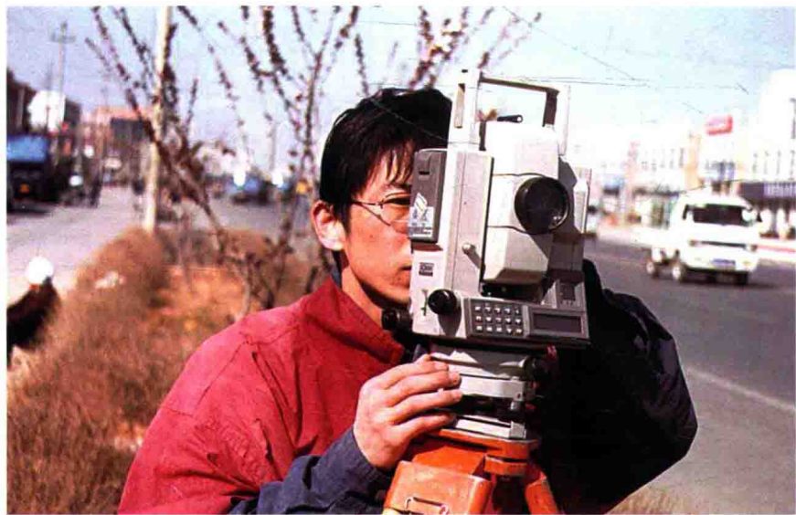
1998年，测绘技术人员采用全站仪采集数据
