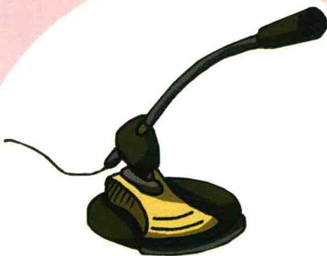
麦克风的学名为传声器，是将声音信号转换为电信号的能量转换器件，也称话筒、微音器。
