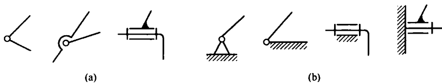
图 2.4 转动副的表示方法 (a) 两构件为活动构件; (b) 有一构件固定。
