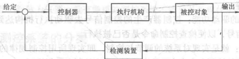
图 1-4 闭环控制示意图
