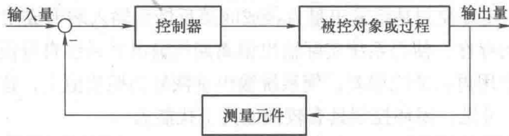
图 1-5 测控系统基本原理示意图
