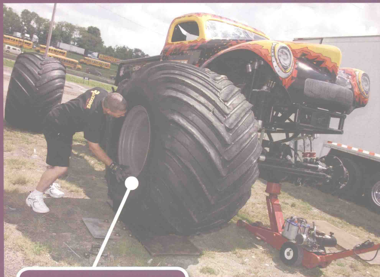
工人正在给大脚车安装巨型轮胎。
