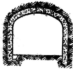
圖 5 混凝土支柱的 巷道断面
