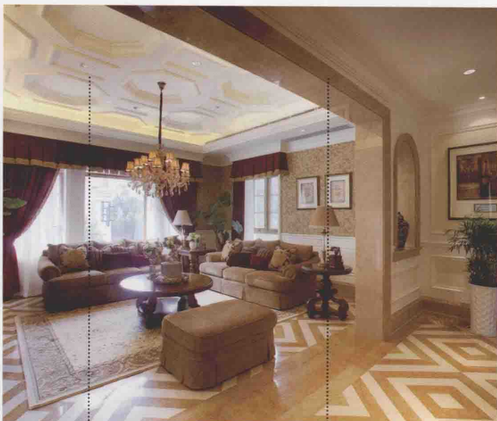
石膏板吊顶 天然大理石壁砖装饰垭口
