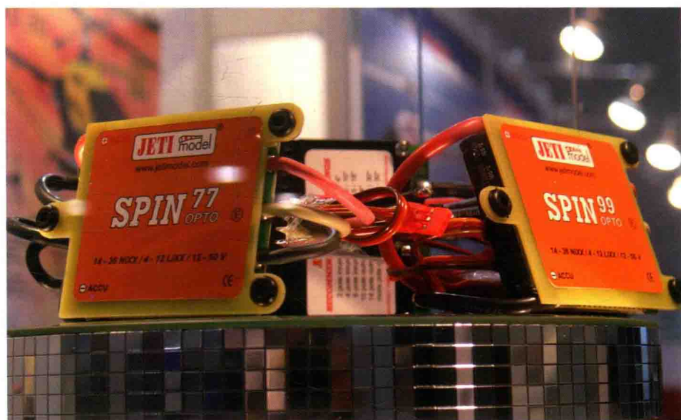
图 1-2 电调是连接电源和电机的桥梁
