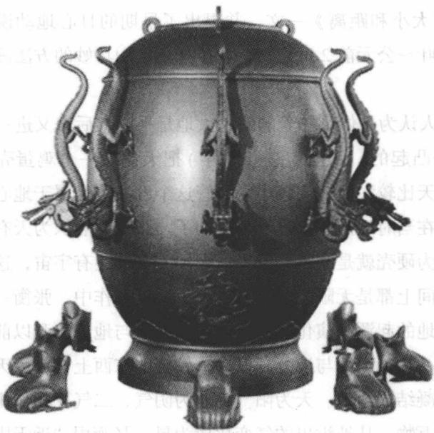
外面有8条龙，每条龙的龙头朝下，分别伸向8个不同的方向，每条龙的嘴里都衔着一个小铜球，正下方蹲着8只张着嘴的蟾蜍。如果在某一方向发生了地震，柱子就会倒向那个方向的横杆，位于那个方向的龙嘴就会吐出铜球，落到蟾蜍的嘴里。这样，人们就可以知道在什么方向发生了地震。公元138年，地动仪准确地测到了发生在陇西的一次地震。当时，地动仪上冲着西面的那条龙，突然张嘴吐出铜球，“哐当”一声，铜球落在下面蹲着的蟾蜍嘴里。几天之后，从陇西传来了消息，在龙吐出铜球的那一天，那里发生了地震。遥远的地震被地动仪测出来了。这个地动仪比欧洲的地震仪要早出1700多年。张衡还发明了测定方向的候风仪，制成了当时只是在传说中有过的指南车。
