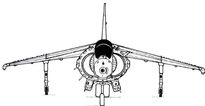
机翼下反角(美国海军 AV-8B “鹞”式攻击机)
