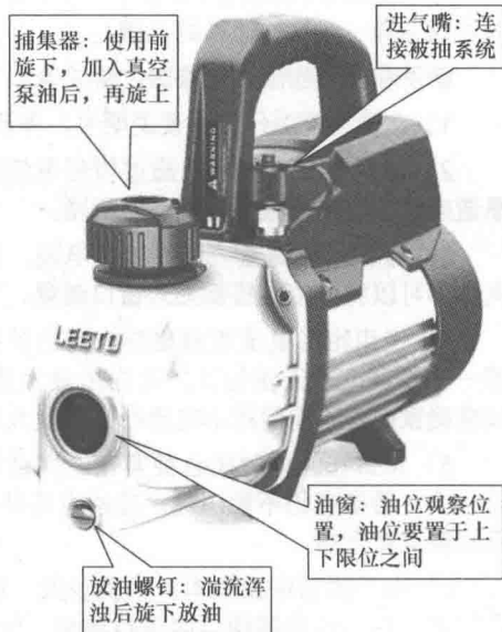
图1-3 真空泵外形结构
