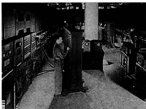
图 1-1 第一台电子数字计算机
