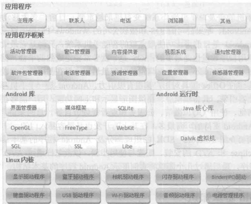
图 1-1 Android 操作系统的层次结构
