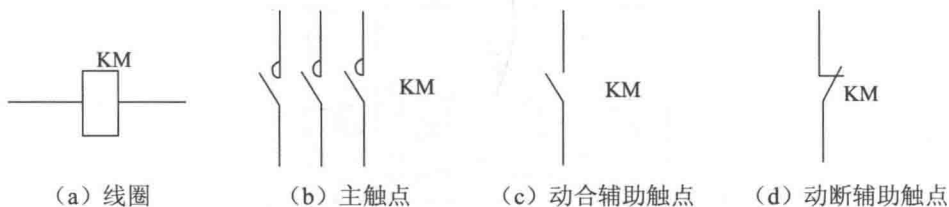
图 1-15 接触器的图形符号和文字符号
