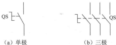
图 1-9 组合开关的图形、文字符号
