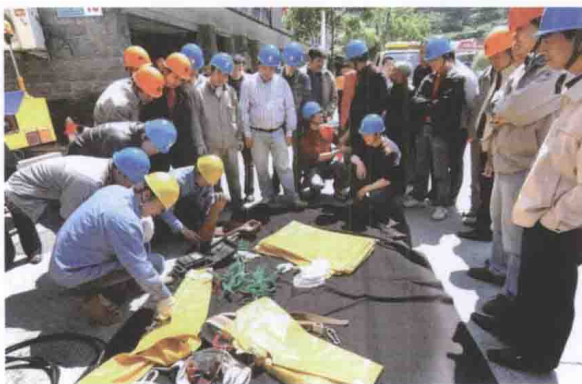
图 1-3 绝缘衣、绝缘裤的绝缘测试
