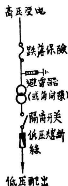
图 1-8 北京地区柱上变压器接线图
