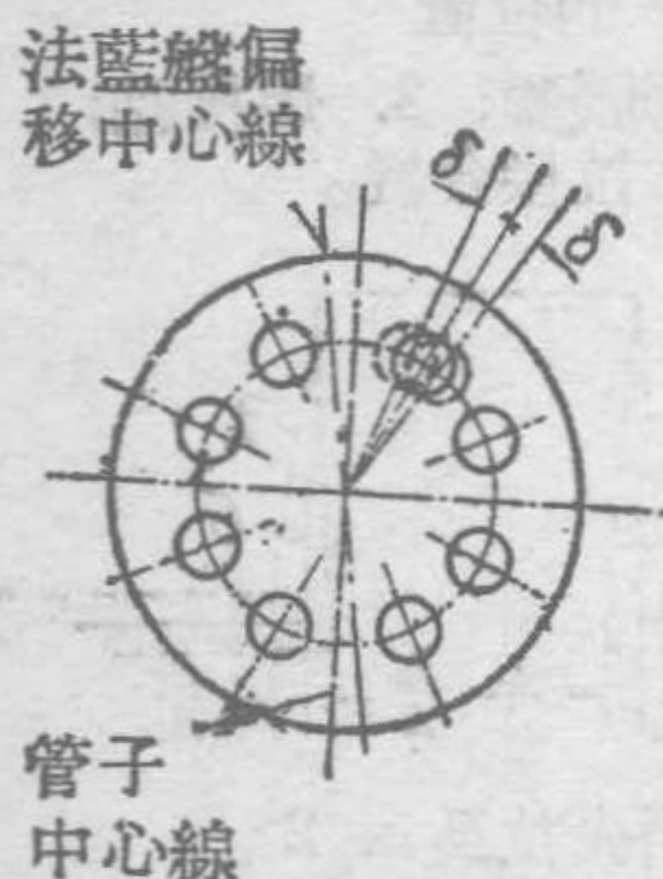
圖18 按圓周測量的法藍盤與管子中心的偏差
