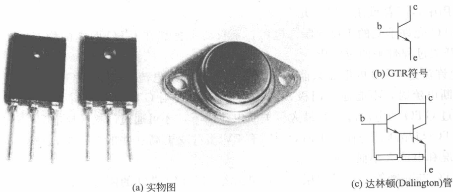
图 1-11 双极型功率晶体管 GTR 实物及其符号
