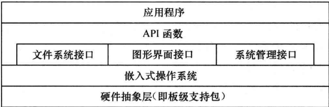
图 1-8 移植了操作系统的嵌入式系统软件结构
