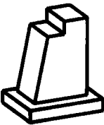
图 1.1-5 桥台的轴测投影
