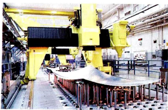
具有柔性夹具的壁板数控钻孔单元
