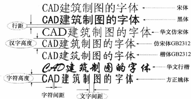
图 1.9 设备专业 CAD 制图字体间距
