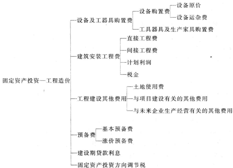
图 1-2 建设工程项目固定资产投资构成
