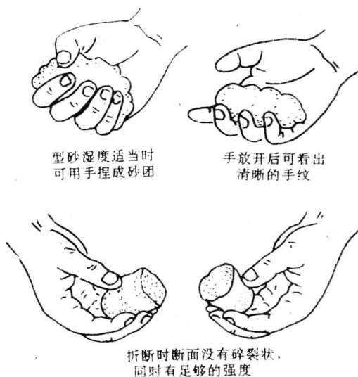
图 1.1-2 手捏法检验型砂
