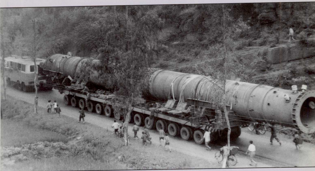
大件公司为川化运输的350吨尿素合成塔体
