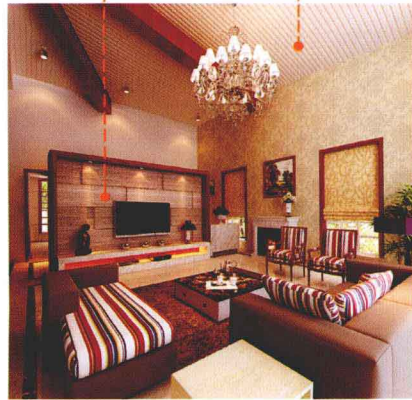
木纹大理石凹凸铺贴 杉木板吊顶刷白
