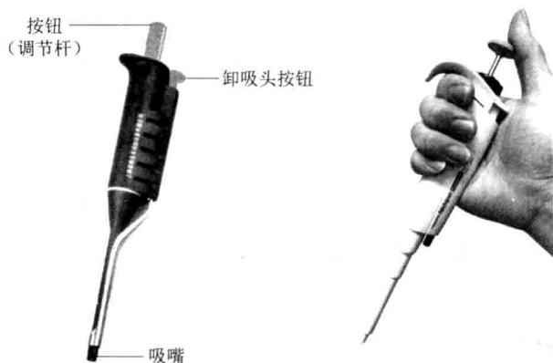
图3 可调式移液器的结构及其使用姿势
