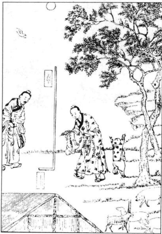
图 1-2 《钦定书经图说》中以表杆测影的定向方法
