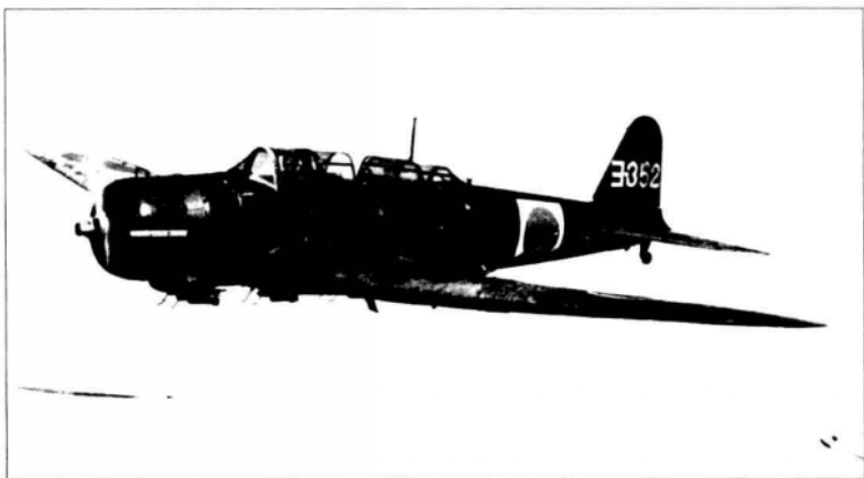
●珍珠港作戰水平爆擊隊與雷擊隊主戰機型——「中島九七」艦攻12型（B5N2）。設計師中村勝治，1937年12月制式採用。B5N2裝1台離升出力1000馬力的「榮」11型氣冷發動機，最大時速378公里，航程1224～2148公里，標準掛配為800公斤炸彈或800公斤魚雷1枚。珍珠港攻擊中共有143架「九七」艦攻參戰，其中5架損失。
