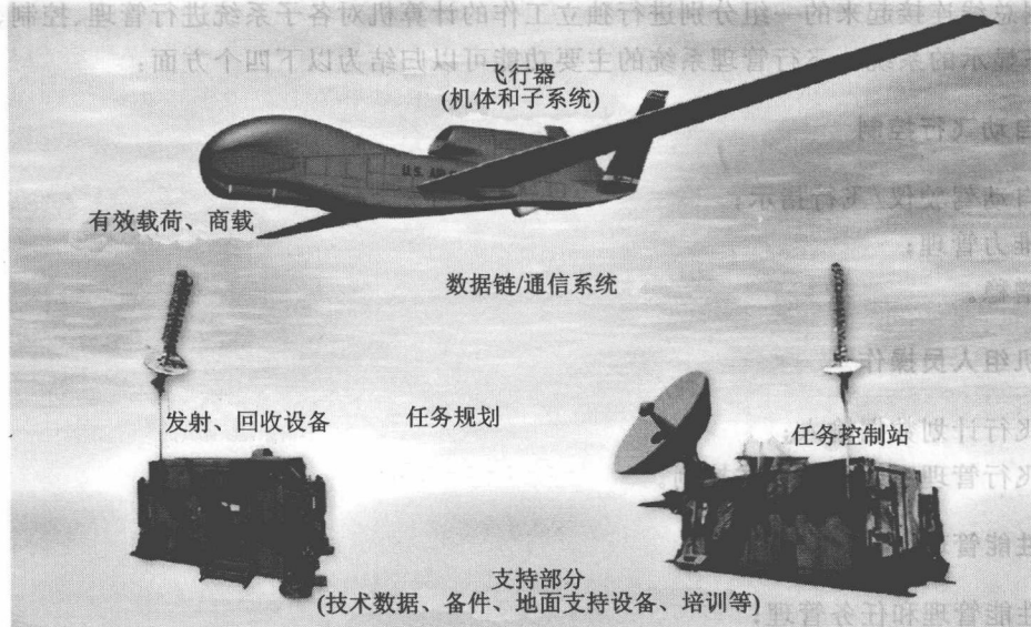
图 1-1 无人机系统(UAS)的组成(示例)
