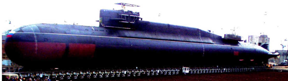
修理中的三角洲級Ⅳ型Delta 在芬克斯的突維德海軍造船廠進行大修的DeltaⅣ型，可看見平時不易看見的水線以下結構。<TASS>
