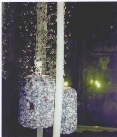
通电后，充气泵连接的气头逸出空气
