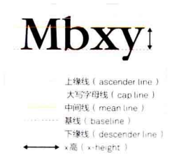
图1 在听写用的笔记本里，以显著的红线来表示西方语系文字的那条重要标准位置的基线。其他水平线的名称如图所示，有些字体的上线线与大写字母线是同一条线。
