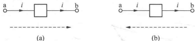
图 1.2.2 电流的实际方向与参考方向的关系
