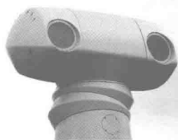
图 1.3.1 荷兰 SIRIUS 舰载红外搜索与跟踪系统
