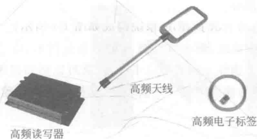
图 1-2 低频和高频 RFID 系统的三个基本要素
