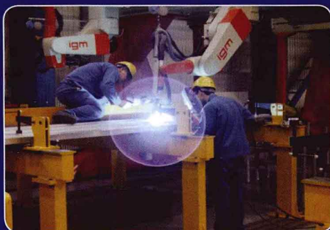
90 米双机器人焊接生产线
