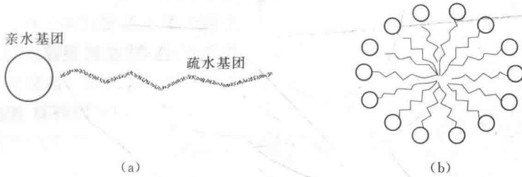
图 2.1 表面活性剂 (a) 分子结构；(b) 胶束示意图
