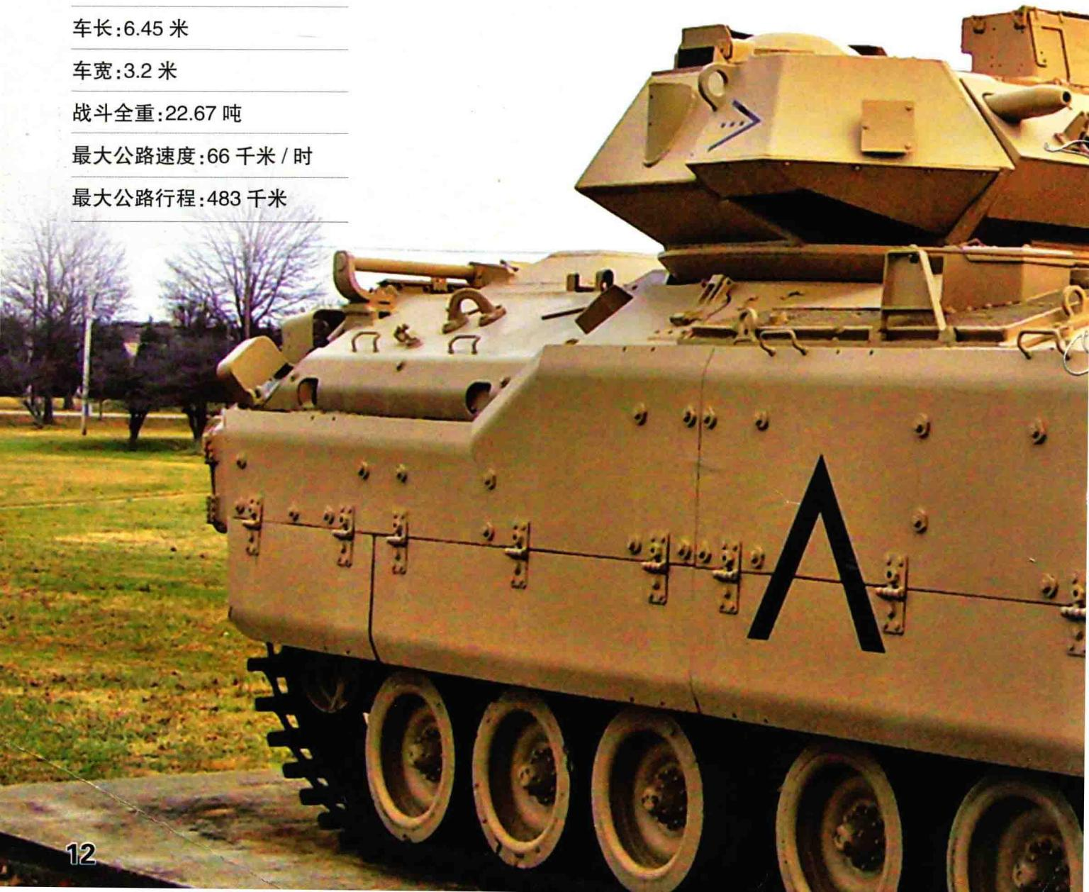
M2 步兵战车于 1983 年正式装备美军，总产量约为四千辆。M2 步兵战车配备了各式先进武器，足以使该型步兵战车应付各种紧急情况。M2 步兵战车有着优秀的远程目标识别能力，在海湾战争中为美军的主战坦克提供了大量伊军远程目标方位，从而大大加快了战争进程。M2 步兵战车装甲防护力较强，能抵御穿甲弹和炮弹的攻击。但该车上没有激光测距仪和定位导航系统，在沙漠中易迷失方向。
