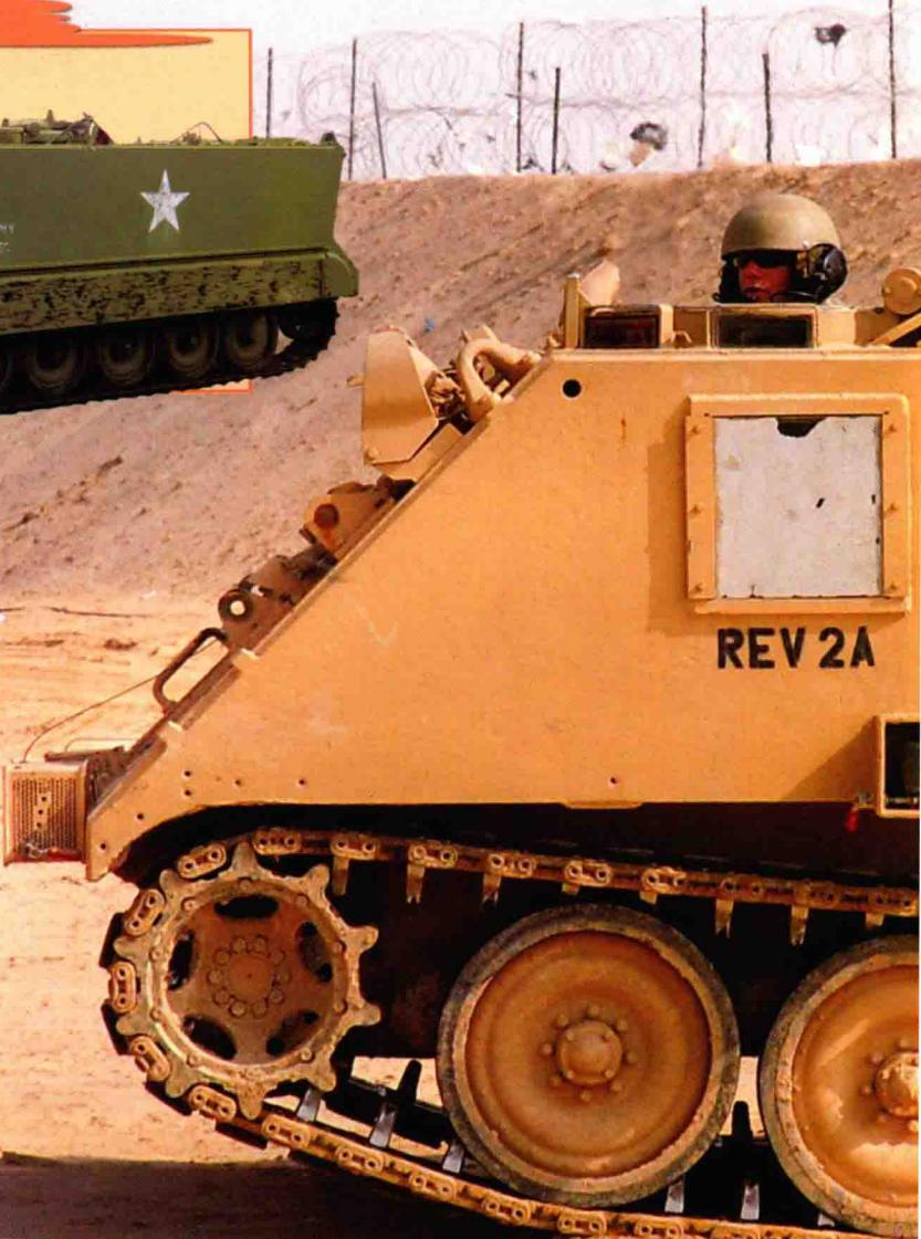
M113 装甲人员运输车是美国现役的制式装甲人员运输车,其越野机动性能优越,可空投、空运,并且是一种水陆两用的装甲人员运输车。其中,M113A2 装甲人员运输车发动机功率较高,悬挂系统采用了高强度扭杆,增加了减震设备,油箱防护力增强,车体开有射孔,步兵可在车上战斗。M113A3 装甲人员运输车安装了附加装甲,并配有涡轮增压柴油发动机、扭杆悬挂装置、液压减振器和挂胶履带等。此外,该车车底加装了防地雷装甲,车内安装了三防探测仪、自动灭火系统和自动报警器等。
