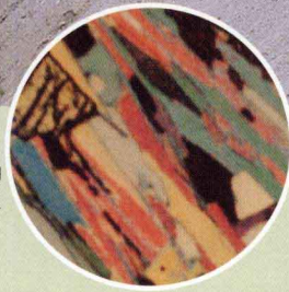
→ 光學顯微鏡下的白雲母礦物呈長條型排列，具有藍、綠及粉紫色等干涉色光學性質。
