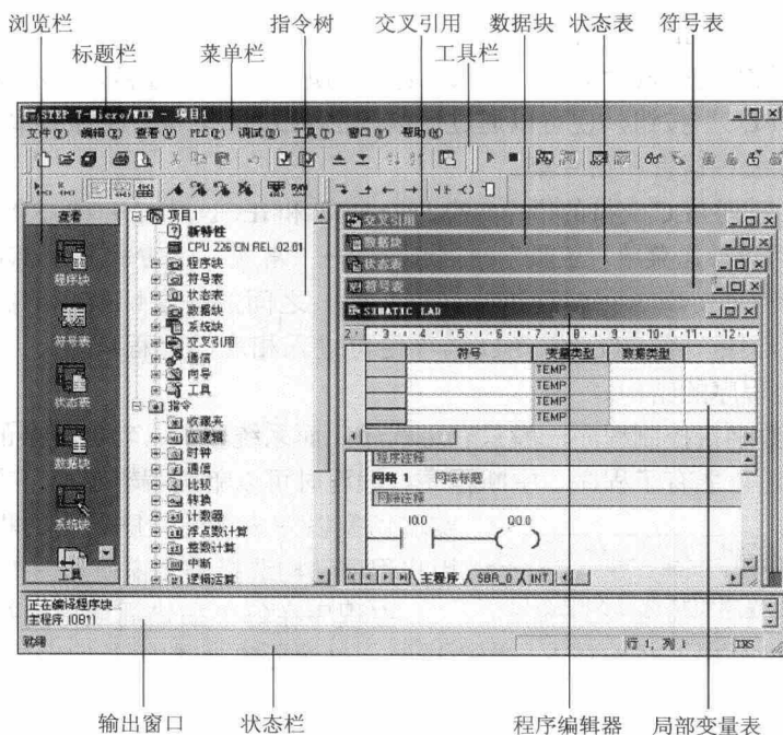
图 1-6 STEP7-Micro/WIN32 编程软件的主界面
